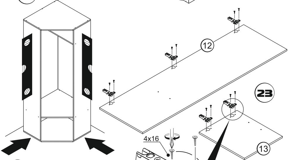
! Установите шкаф к стене, в место постоянного нахождения. Отрегулируйте вертикаль и горизонталь путем регулировки ножек, используя уровень.
